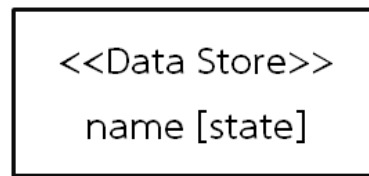
ภาพที่ 8.53 สัญลักษณ์แทนที่เก็บข้อมูล(data store)
